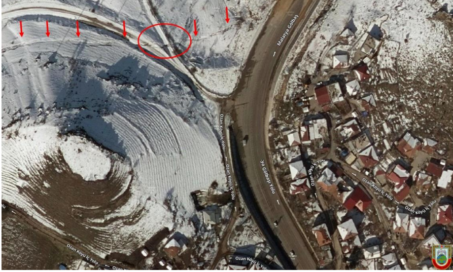
Şekil 7. Ozan Köyü'nün kuzey çıkışındaki tali yolda gözlenen 2.10 m yer değıştirme
